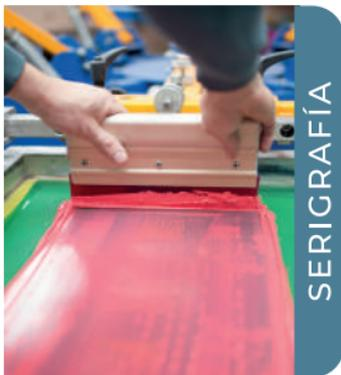
La serigrafía es un método de estampación que nos permite transferir imágenes trazadas en una plantilla sobre una malla con tinta, a una superficie. Esta técnica es muy recomendada al reproducir una misma imagen miles de veces de manera muy rápida.
