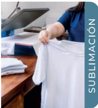
La sublimación es una técnica de personalización que permite transferir una imagen a una prenda de poliéster, o a un artículo con recubrimiento de poliéster. Esta transferencia se logra aplicando calor con una plancha transfer.
